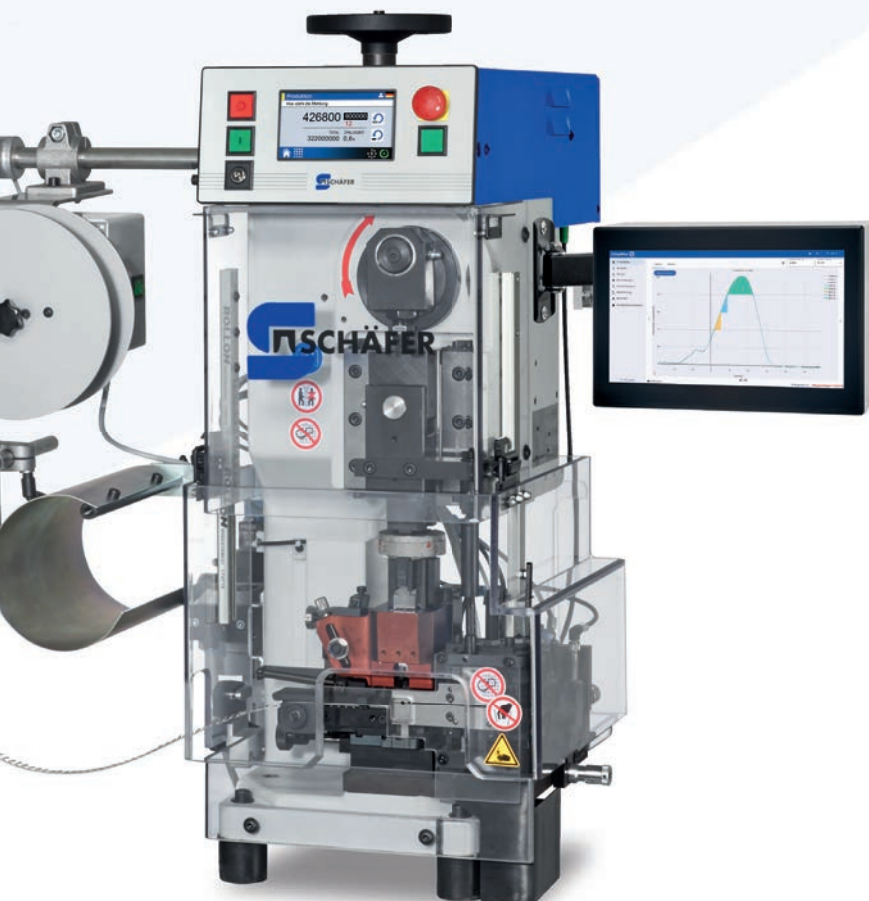
CrimpWise eM zur externen Montage an Crimpmaschinen.
